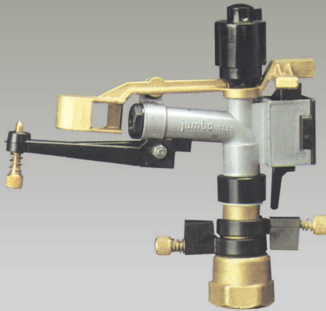
Irrigatore di piccola portata, costruito in ottone, lega leggera e rilsan a settori; è dotato di ugelli intercambiabili e di rompigetto registrabile. Data la forte inclinazione del getto si può impiegare per l'irrigazione sottocochima di vigneti e frutteti, per l'irrigazione di colture in serra ed in zone fortemente ventilate.
