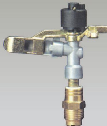
Irrigatore di piccola portata, costruito in ottone, lega leggera e rilsan a settori e circolare; è dotato di rompigitto registrabile. Data la forte inclinazione del getto si può impiegare per l'irrigazione sottochioma di vigneti e frutteti, per l'irrigazione di colture in serra ed in zone fortemente ventilate.
